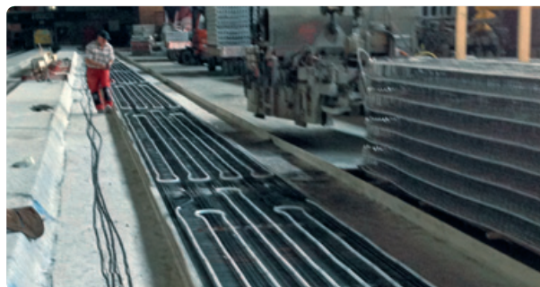
Thermisch aktivierte Spannbeton Fertigdecken werden werkseitig mit vorgefertigten Modulen zum Heizen/Kühlen ausgestattet
